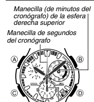
Manecilla (de 1/20 seg. del cronógrafo) de la esfera central *Esta manecilla gira e indica la cuenta de los segundos durante los primeros 60 segundos.
